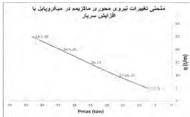
شکل 5- منحنی تغییرات نیروی محوری ماکزیمم در میکروپایل با افزایش سربار
