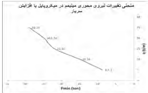
شکل 6- فن‌چیت تغییرات نیروی محوری میکروپیل‌ها با افزایش بار
